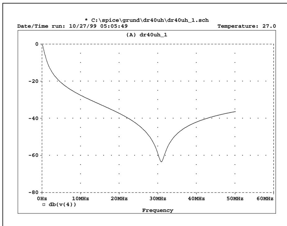
Mit diesem linearen Modell wird die frequenzabhängige Impedanz der Drossel bis 50 MHz brauchbar beschrieben. Nichtlineare Effekte im Kernmaterial werden nicht erfaßt. Durch den konstanten Verlustwiderstand  $R_s = 4 \Omega$  wird der frequenzabhängige Güteverlauf nicht modelliert.
