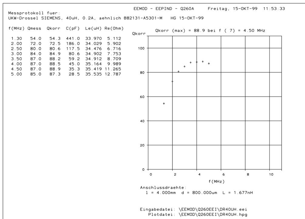
Wie bei allen Spulen mit magnetischem Kern, die weit unter ihrer Eigenresonanz betrieben werden, ergibt sich ein Gütemaximum, das hier bei etwa 4.5 MHz liegt. Die Induktivität der Anschlußdrähte bei der Messung ist mit etwa 1.7 nH so klein, daß wir sie nicht berücksichtigen müssen. Der aus der Güte  $Q_{\text{korr}}$  berechnete Reihenverlustwiderstand  $R_e$  (Ohm) steigt mit der Frequenz stark an.
