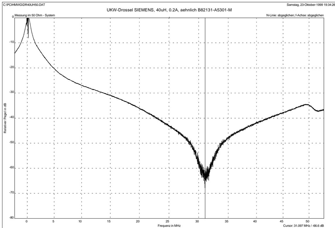
Aus der Parallelresonanz bei etwa 31.1 MHz und  $L = 34 \mu\text{H}$  errechnen wir eine Parallelkapazität  $C_p \approx 0.78 \text{ pF}$ . Aus der Dämpfung von etwa 63.5 dB im Resonanzpunkt ergibt sich ein Ersatzparallelwiderstand  $R_p \approx 150 \text{ k}\Omega$ . Oberhalb der Resonanz nimmt die Impedanz mit der Frequenz ab, d.h. die Drossel verhält sich dort wie eine verlustbehaftete Kapazität.
